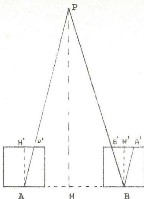
Si pone la tavoletta col foro in A e, guardando attraverso di esso, si allinea il filo con la direzione di P; poi, spostando la tavoletta parallelamente alla base AB, ci si porta in B e si torna a puntare in P allineando nuovamente il filo. Si costruisce così sulla tavoletta un triangolo A'B'P' simile al triangolo ABP; quindi le altezze dei due triangoli saranno nello stesso rapporto delle due basi. Si potrà quindi determinare la distanza incognita PH:
