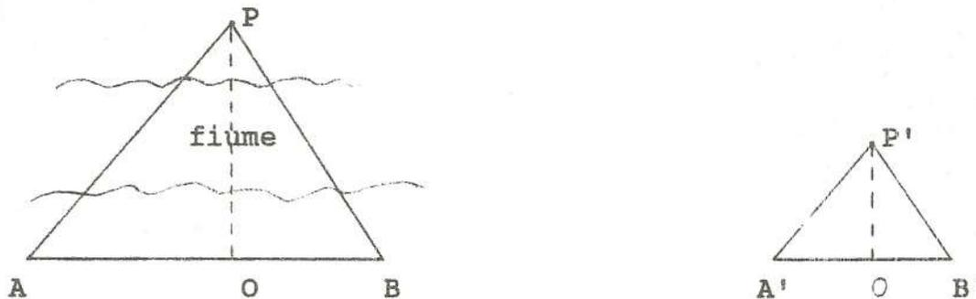
Da A si punta verso P e si misura l'angolo  $\widehat{PAO}$ ; da B si punta verso P e si misura l'angolo  $\widehat{PBO}$ ; poi si misura la base  $\overline{AB}$ . Su un foglio si costruisce un triangolino  $A'B'P'$  simile ad  $ABP$  e, poichè si è già visto che tutti i segmenti corrispondenti stanno in proporzione, si può scrivere
