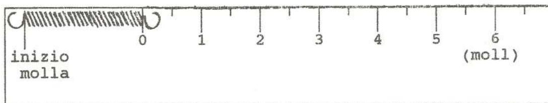
Si traccia quindi un segno ogni due centimetri a destra dell'ultima spira della molla, realizzando la scala del dinamometro, tarata in  $\text{moll}$ . È utile segnare anche le mezze divisioni.
