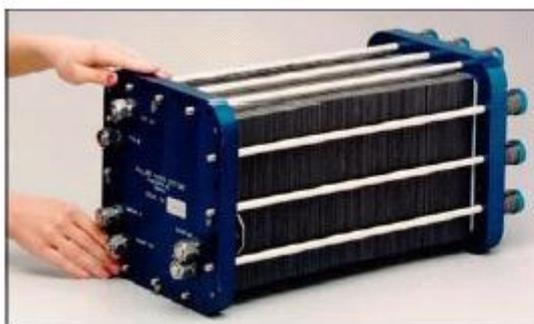
Stack completo, manca ancora il sistema di alimentazione ed umidificazione
