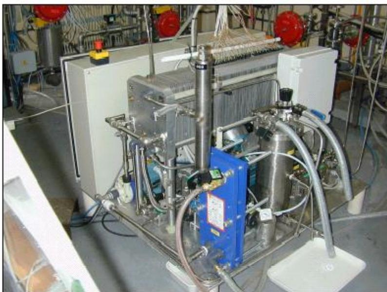
Sistema completo di generazione di energia elettrica a cella a combustibile di 5 kW di potenza presso ENEA
